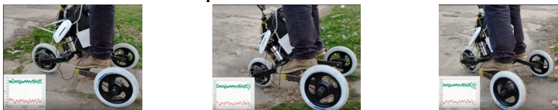
Fig. 6.31 - Studiu dinamic la coborârea unei pante cu denivelări.
