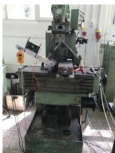
Fig. 6.10 - Măsurători folosind traductoare tensometrice pentru brațele punții spate din aluminiu fără sistem elastic de amortizare
