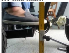
Înălțimea punții spate cu încărcare de 77 kg este 190 mm
