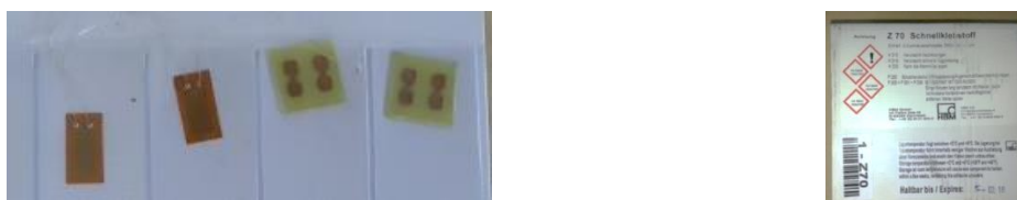
Fig. 6.3 - Traductoare tensometrice si adezivul utilizat
