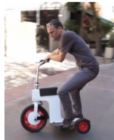
Triciclu Acton M efectuând un viraj unde una din roți se ridică de la sol
