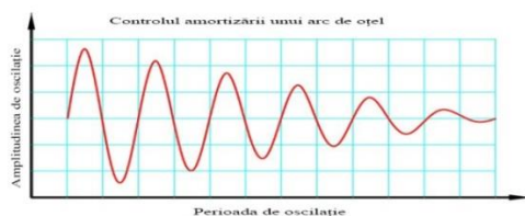
a) Controlul amortizării unui arc de oțel
