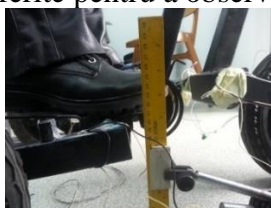
Înălțimea punții spate cu încărcare de 44 kg este 204 mm
