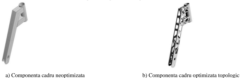
Fig. 7.5. - Cadrul triciclului , a) înainte de optimizare, b) după optimizare
