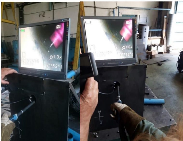
Fig. 5.4. Repararea prin sudare a probelor [31, 33]
