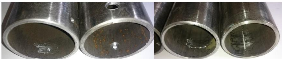
Fig. 4. 6. Produse de tip țevă cu defecte create artificial
