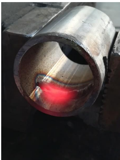
Fig. 5.8. Proba 5 – defect liniar poziționat pe circumferință
