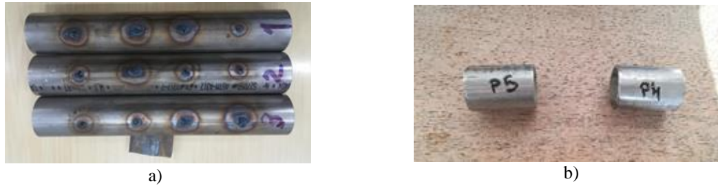
Fig. 6.2. Curățirea suprafețelor, a) Probele 1÷3 - defecte circulare, b) Probele 4 și 5 - defecte liniare
