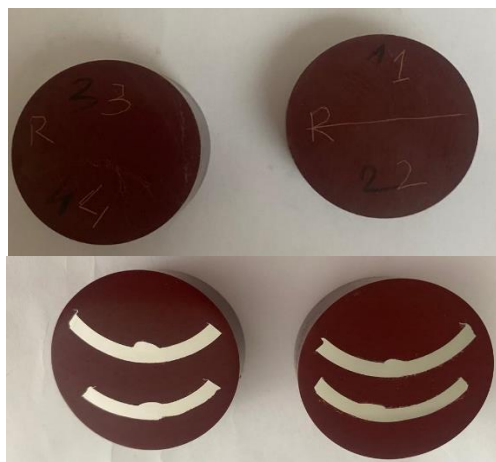
Fig. 6.9. Proba 2 - poziționarea punctelor de sudare [33], 2.1. - punctul 1 - 50 mm; 2.2 - punctul 2 - 100m; 2.3. - punctul 3 - 150 mm; 2.4 - punctul 4 - 200 mm [33].
