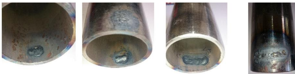
Fig. 4. 7. Imagini cu probe tip țevă după repararea prin sudare
