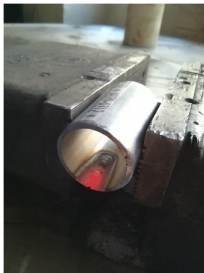
Fig. 5.9. Proba 4 –defect liniar poziționat pe lungimea țevii
