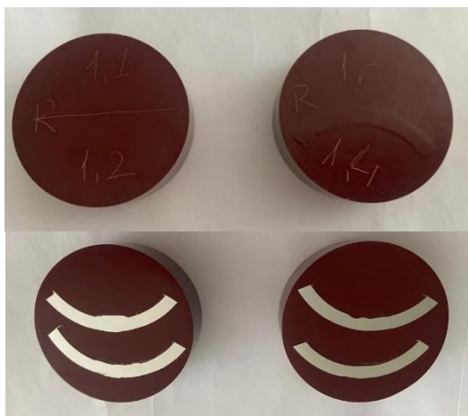
Fig. 6.8. Proba 1 - poziționarea punctelor de sudare [33], 1.1. - punctul 1 - 50 mm; 1.2 - punctul 2 - 100m; 1.3. - punctul 3 - 150 mm; 1.4 - punctul 4 - 200 mm [33].
