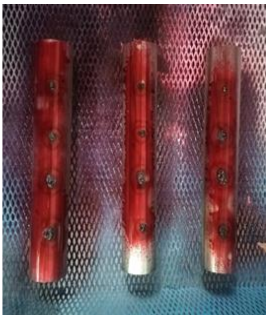
Fig. 6.3. Aplicare penetrant - probele 1÷3
