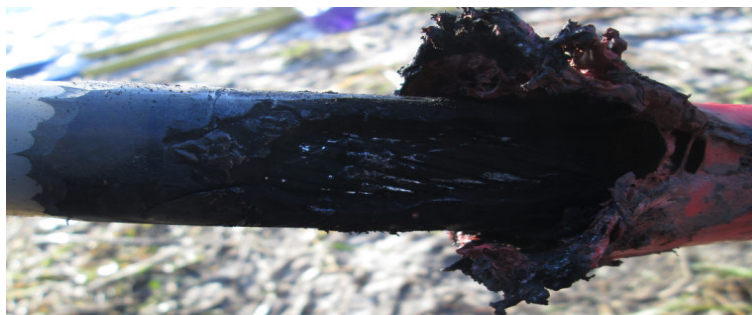
Fig.3.Străpungerea izolației în zona capului terminal[16]
