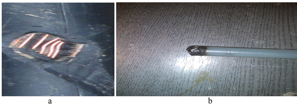
Fig.7. Vizualizarea locului de străpungere a izolației: a) după îndepărtarea învelișului exterior; b) după îndepărtarea stratului semiconductor
