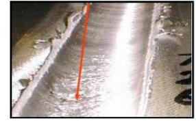
Fig. 2.3.4. Uneven seam [B01]
