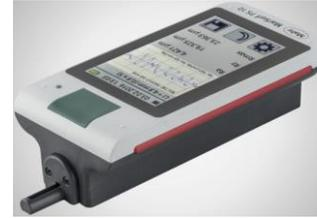
Fig. 6.8.1. MAHR type PS-10 rugosimeter
