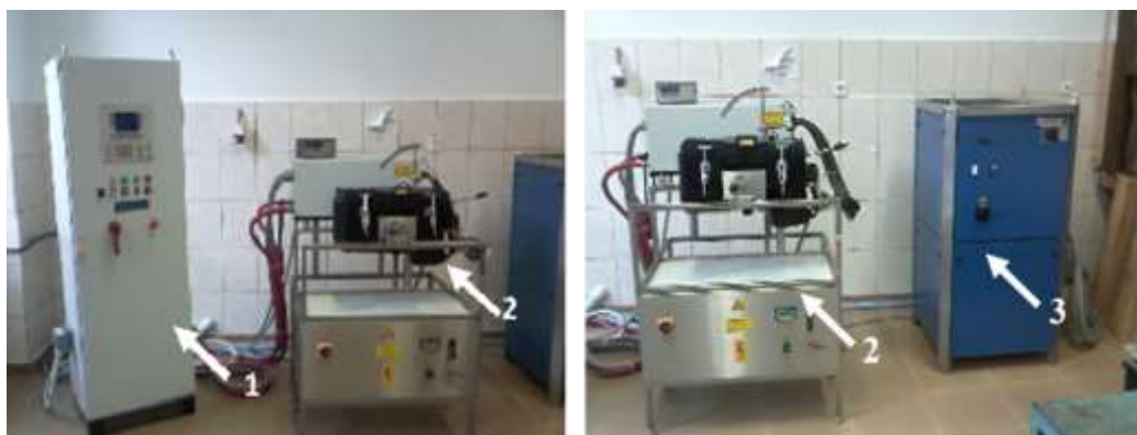
Figura IV.1 - Cuptorul cu inducție Linn MFG – 30: 1 – generator de tensiune; 2 – camera de topire; 3 – recirculator de apă de răcire
