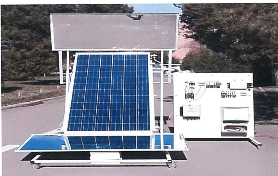
**Fig. 11** Modelul experimental al PFVT echipat cu elemente de concentrare a energiei solare
