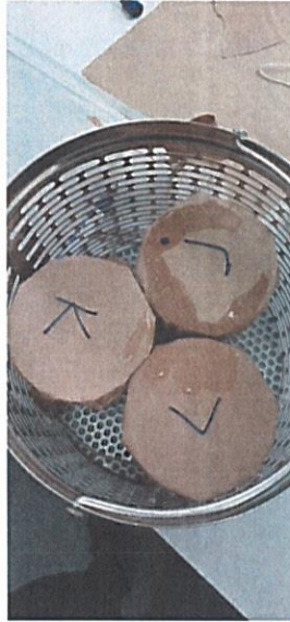
I. Autoclavizarea probelor MS/ZnO, pentru fixarea stratului oxidic de zinc la o temperatură de T = 110^\circ - 150^\circ \text{C} , t = 15 - 30 \text{ min}
