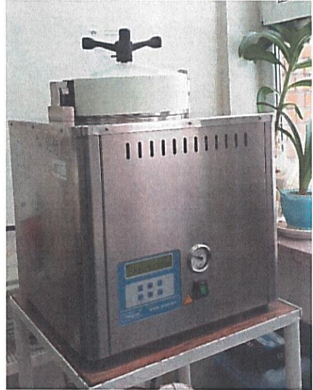
I. Autoclavizarea probelor MS/ZnO, pentru fixarea stratului oxidic de zinc la o temperatură de T = 110^\circ - 150^\circ \text{C} , t = 15 - 30 \text{ min}
