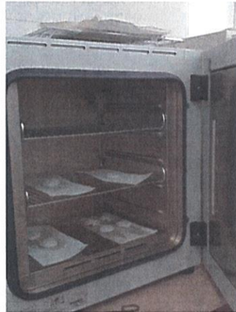
II. Uscarea la Etuvă a probelor, Materiale Suport funcționalizate cu ZnO (SpongeMat/ZnO), t = 24 \text{ h}
