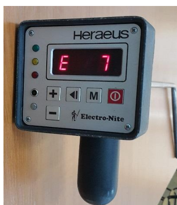
Fig.2.2. Lance portabilă de imersie pentru măsurarea temperaturii
