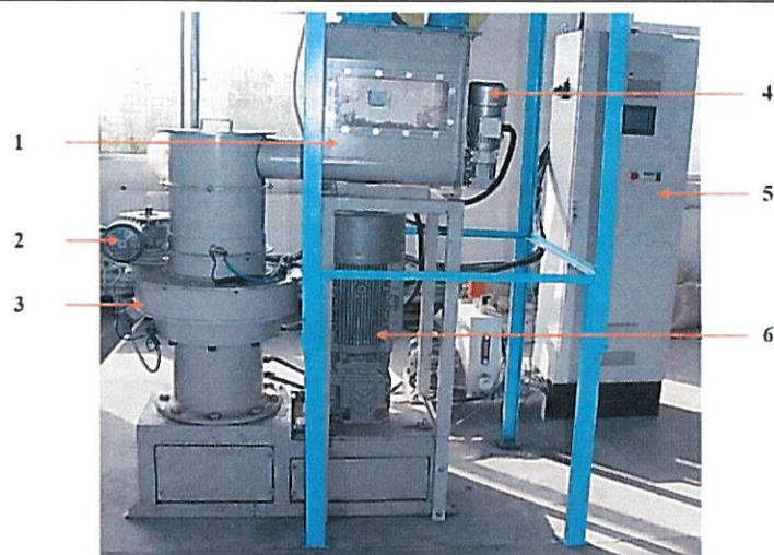
Fig. 6.6. Echipament de peletizare cu matriță inelară utilizat pentru realizarea experimentărilor
