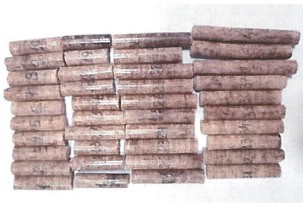
Fig. 6.7. Pelete obținute cu mașina de peletizat cu matriță inelară
