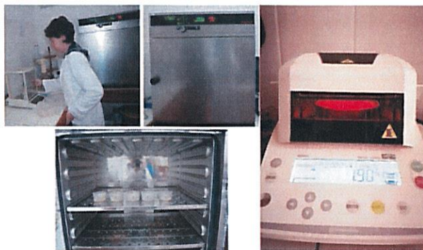
Fig. 5.2. Determinarea umidității probelor la etuvă (stânga) și la termobalanță (dreapta)
