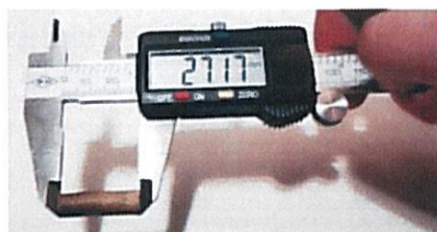
Fig. 5.17. Detaliu din timpul măsurătorilor lungimii peletelor
