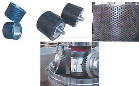
Fig. 3.4 Exemple de role de presare
