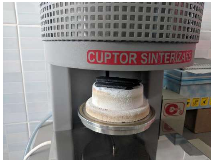
Fig. 4. 5 Introducerea oțelurilor laminate în cuptorul de incalzire în vid
