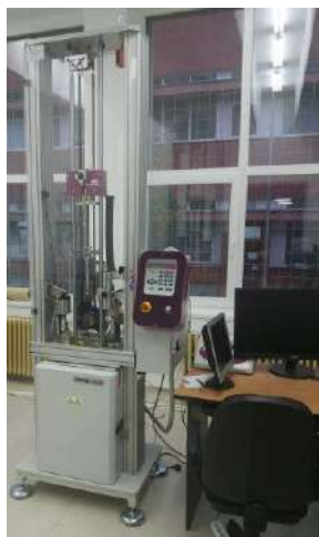
Fig. 6. 1 Ansamblul experimental destinat încercărilor dinamice la impact: 1 – echipament INSTRON Ceast 9340 (SUA); 2 – unitate PC prevăzută cu sistem de achiziții de date;
