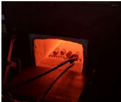
Fig. 4. 4 Încălzirea probelor în cuptor la temperatura de 1150°C
