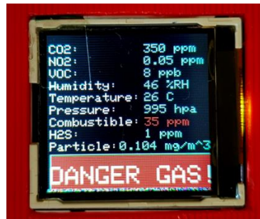
Fig. 6.5 Informațiile afișate pe display cu o alarmă declanșată atunci când apare o concentrație mare de gaz combustibil
