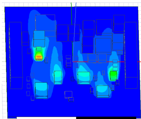
Fig. 6.11 Simulare termică folosind direcționarea aerului cu filtru
