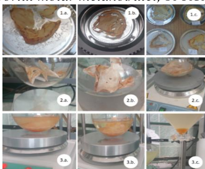
Fig. 7. 6. Etape în utilizarea BC drept catalizator eterogen pentru conversia uleiurilor vegetale la biodiesel: 1.a-c – tratament termic; 2.a-c – activare pre-reacție transesterificare; 3.a-c. – reacție transesterificare
