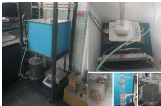
Fig. 3.18. Schema reală a instalației de adsorbție de laborator: Intergral, cameră cu coloana de adsorbție, compressor, barbotor, cameră silicagel
