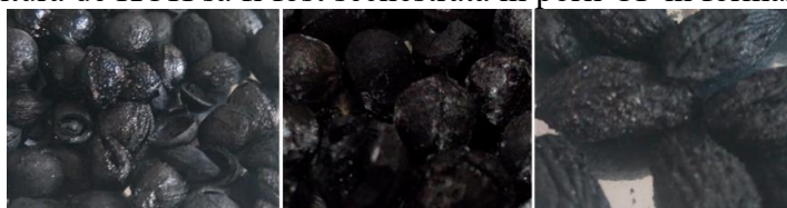
Fig. 3.13. CP I la final de P I, cu urme de KOH pe suprafața externă
