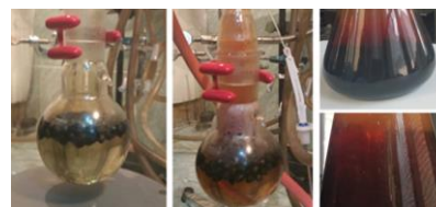
Fig. 5.4. Imagini de la funcționalizarea cu acid azotic: inițiere reacție și parcurg reacție
