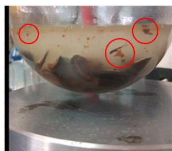
Fig. 3.51. Particule solide în mediul de reacție, cu acțiune posibilă de inhibitori sau generatoare de operații suplimentare de centrifugare
