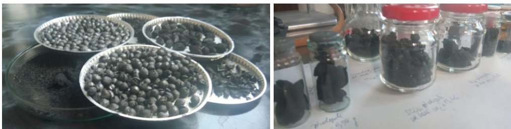
Fig. 3.41. Material catalitic din biomasă lignocelulozică obținut în urma pirolizei și activării termice
