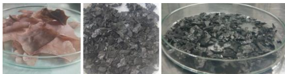
Fig. 3.62. BC înainte și după piroliză
