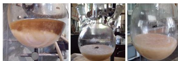
Fig. 4.8. Amestecul de reacție la final de distilare, – răcire la t mediu , aspect ceros, bej-marou deschis
