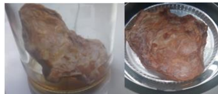
Fig. 5. 14. BC depozitată în metanol, uscată și tratată cu Gu
