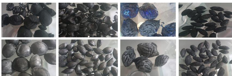
Fig. 3.22. Carbon pirolitic din sâmburi de fructe: rândul de jos piroliza I (s. netratați) ; rândul de sus piroliza II (s. tratați)
