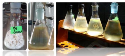
Fig. 4.17. Produși finali la sinteza guanidinei: \text{MeKSO}_4 - stânga, guanidină - dreapta.
