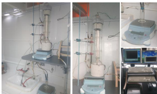
Fig. 3.18. Instalția de piroliză de laborator: instalație coloană piroliză, vas bio-ulei, colectare și prelucrare date
