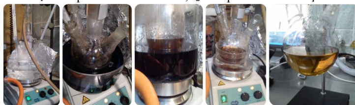
Fig. 4.5. Amestec de reacție la sinteza guanidinei, de la stânga la dreapta: inițiere reacție –formarea guanidină hidrogen metil sulfat
