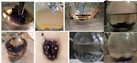
Fig. 5.6. Combinare guanidină cu suportul catalitic de tip carbon, prin impregnare și distilare
