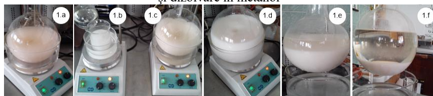
Fig. 4.10. Precipitarea cu metoxid: 1.a.- amestec de reacție dizolvat; 1.b - preparare metoxid; 1.c -alimentare metoxid; 1.d - reacție; 1.e, 1.f – precipitare.
