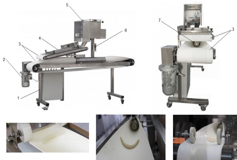
Fig.3.3 Formator pentru covrigi model CO.FO 63/47, [192]
