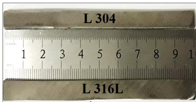
Fig. 6.2 Epruvete standard (SSC) nesudate din oțel inoxidabil austenitic AISI 304 și AISI 316L
