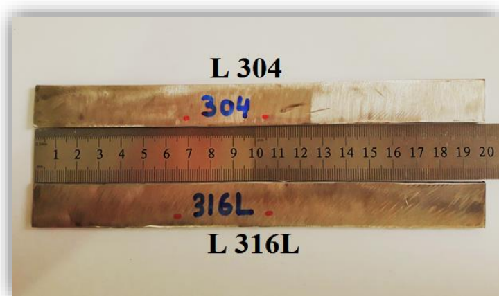
Fig. 5.1 Epruvete standard de coroziune AISI 304 și AISI 316L – oțeluri inoxidabile austenitice
