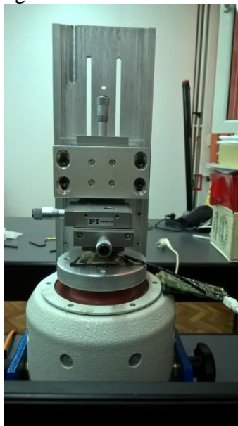
Fig. 5.22. Sistemul de poziționare al lamei cu magneți
