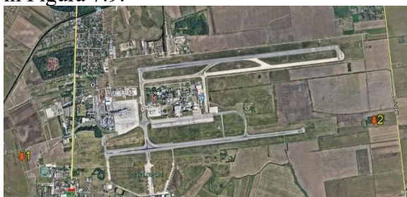
Figura 7.9 Punctele 1 și 2 în care s-au efectuat măsurări de zgomot la decolare, respectiv aterizarea aeronavelor
