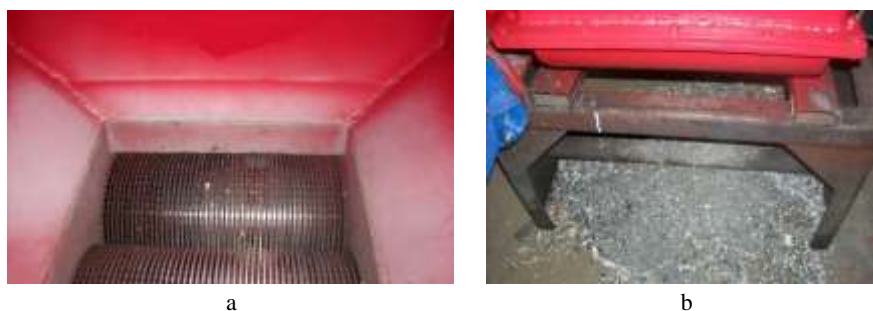
Fig. 6.56. Rotoare de tocare prevăzute cu lame tăietoare (a) și aspectul tocăturii rezultate (b)
