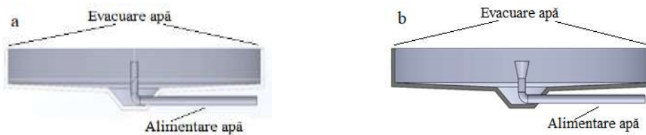
Fig. 5.11. Secțiuni în zona centrală a decantorului cu conductă de alimentare cu diametru constant de 1m (a), respectiv evazată ce ajunge la un diametru de 2 m (b)
