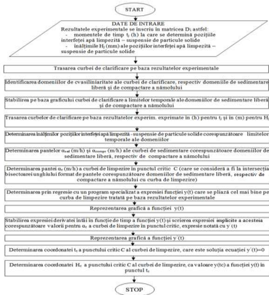
Fig. 5.3. Schema structurală a algoritmului secvențial pentru determinarea punctului critic, [124]
