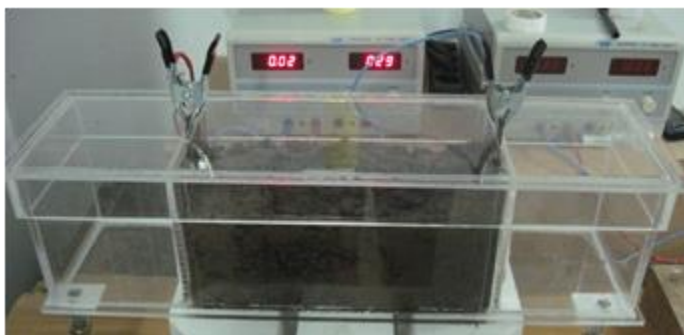
Fig. 4.2. Instalația experimentală utilizată pentru aplicarea tratării electrochimice
