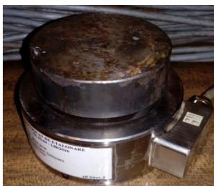
d. Celulă de forță de 200 kN
