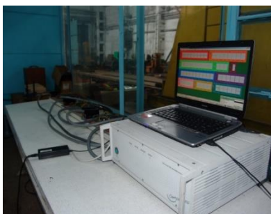
a. Sistem de achiziție de date HBM Centipede cu 100 de canale
