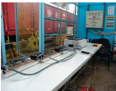
b. Elemente de legătură între traductoare și HBM Centipede
