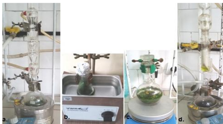
Figura 5.1. Instalațiile de obținere a extractelor din frunze de iederă: a) refluxare, b) ultrasonicare, c) macerare și d) extracție Soxhlet.
