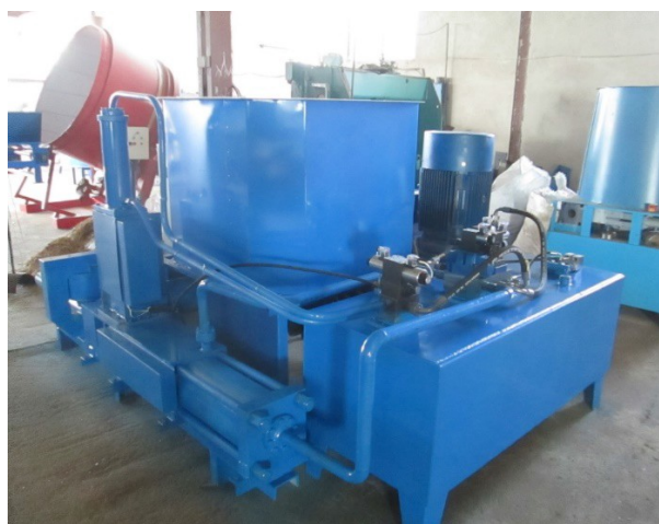
Fig. 2 Presă hidraulică cu piston pentru brichetare
