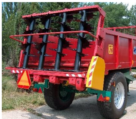
Fig. 3.24. Mașină distribuit cu 4 rotoare verticale cu spira continuă [90]
