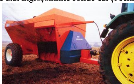
Fig.3.32. Mașină de distribuit îngrășăminte organice cu descărcare în laterala SAMAS [96]
