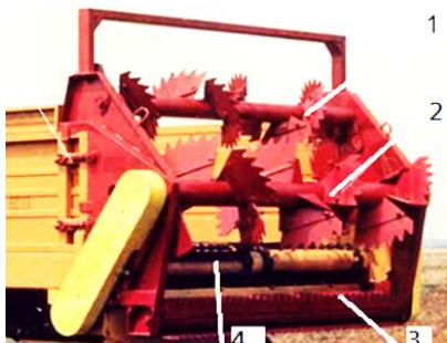
Fig.3.14. Aparatul de distribuție al mașinii MIG 10 1.rotor superior; 2. rotor intermediar, 3 rotor inferior [86]
