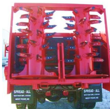
Fig. 3.26. Mașină distribuit gunoi de grajd cu 2 rotoare verticale cu palete [82]
