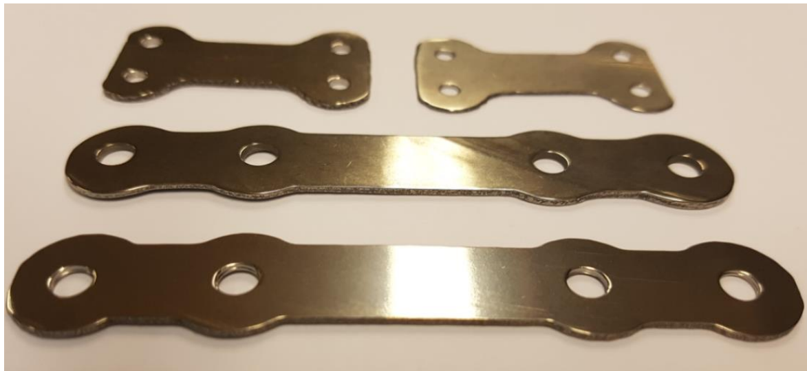
Fig. 4.3 Imagine a plăcutelor ortopedice fabricate prin LMD [78].
