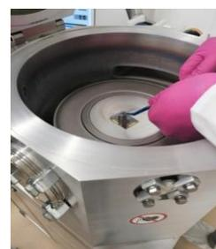
Fig. 7.45. Attaching the PDMS cover
