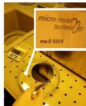
Fig. 9.25. Dezvoltarea cu soluție ma-D
