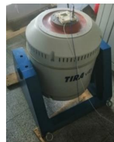
Fig. 9.64. Testarea dispozitivului micro-electro-mecanic la vibrații
