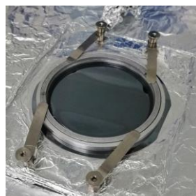
Fig. 7.43. Obținerea stratului uniform de PDMS
