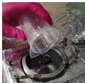
Fig. 7.42. Turnarea PDMS-ului în suport
