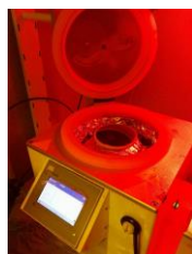
Fig. 7.8. Fotorezistul LOR 10B depus pe plachetă
