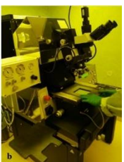
Fig. 7.14. a.) orientarea și b.) fixarea măștii în echipamentul MA6/BA6
