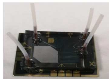
Fig. 9.47. Dispozitivul microfluidic prototip îmbunătățit cu nanoporturi atașate
