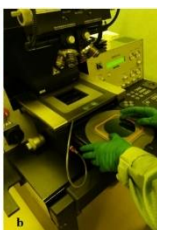
Fig. 7.15. a.) orientarea și b.) fixarea plachetei în echipamentul MA6/BA6
