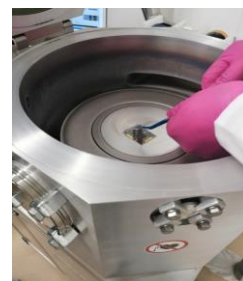
Fig. 7.45. Atașarea capacului de PDMS
