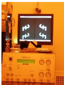
Fig. 9.23. Alinierea efectuată folosind semnele de aliniere
