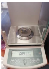
Fig. 9.57. Determinarea masei dispozitivului micro-electro-mecanic, prototip îmbunătățit
