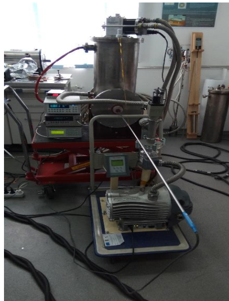
Fig. 7.8. Ansamblul EMSD și sistem de măsură a câmpului magnetic.
