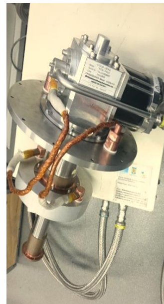
Fig. 6.16. Conductorii de cupru împreună cu criorăcitorul.
