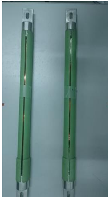
Fig. 6.15. Conductorii HTS asamblați în carcase.
