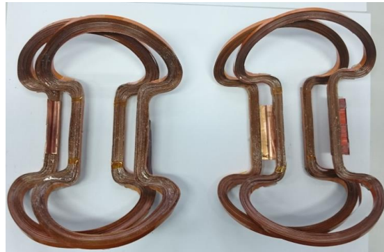
Fig. 6.2. Bobinele supraconductoare HTS de tip „Șa”.
