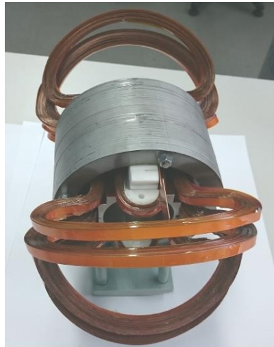
Fig. 6.8. Bobinele HTS și jugul, vedere axial – frontală.
