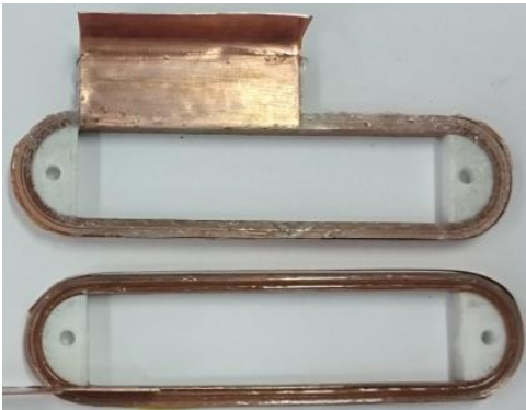
Fig. 6.1. Bobinele supraconductoare HTS tip stadion.
