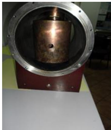
c. Ansamblul criostat – bobine – ecran termic, montate în criostat.
