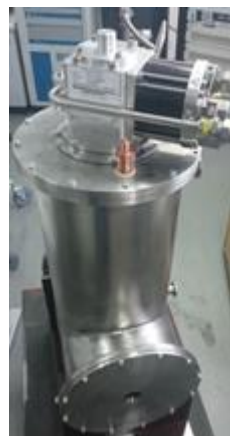
d. Electromagnet supraconductor dipolar (EMSD) asamblat.
