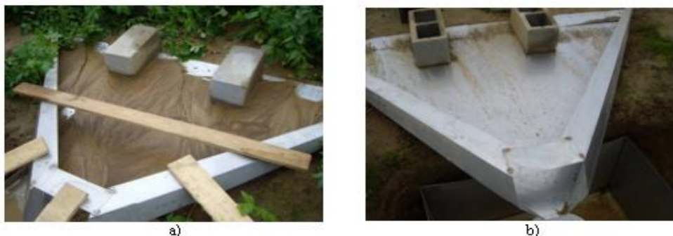
Fig. 2.9. Evidențierea fenomenului de eroziune în cazul brazdelor necompartimentate (a) și în cazul brazdelor compartimentate (b) [102]
