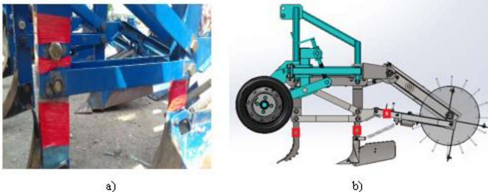
Fig. 4.26. Zonele unde au fost montate mărcile tensometrice la echipamentul DMBC-5 (marcate în roșu)
