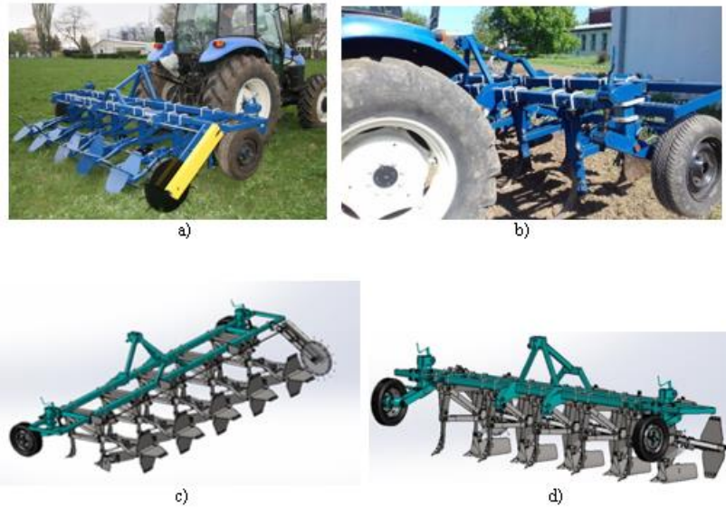
Fig. 2.40. Echipamentul de modelat solul în brazde compartimentate la culturi prășitoare, DMBC-5 (a), (b), (c), (d) [106,108]
