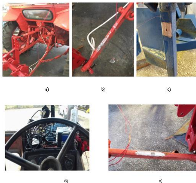
Fig. 4.52. Pregătirea echipamentului pentru determinarea indicilor energetici
