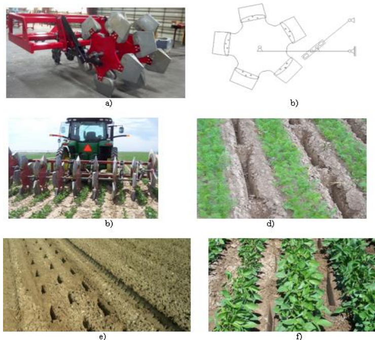
Fig. 2.24. Echipamentul Pocket Pitter pentru realizat amprente în culturi cu distanța mică între rânduri (a), (c), schema cinematică a echipamentului (b) și forma terenurilor amprentate cu echipamentul pentru realizat amprente în culturi cu distanța mică între rânduri (d), (e), (f) [5]
