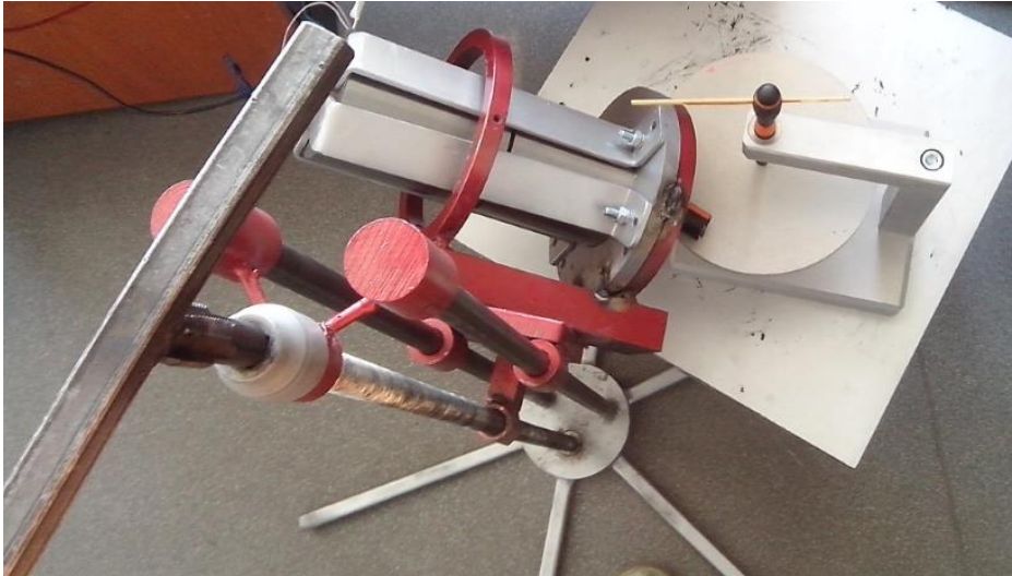
Fig. 5.4. Sistem de poziționare a actuatorului magnetostrictiv, vedere generală.
