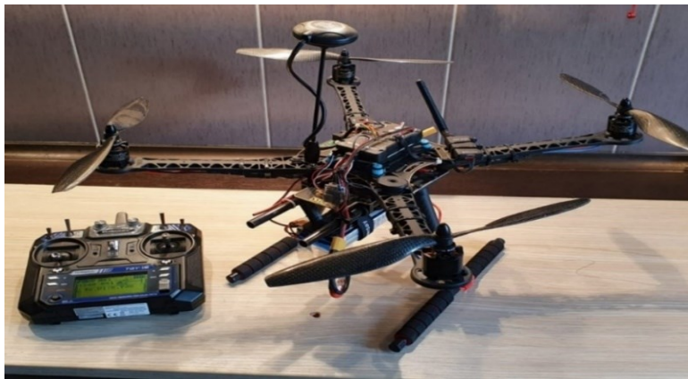
Fig. 4.1. Drona suport proiectată special pentru testare module experimentale
