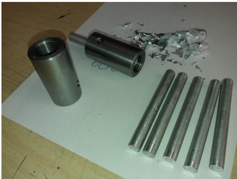
Figura 4.2. Bare turnate din compozit AA6063/ZrB 2
