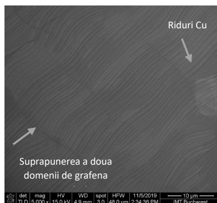
Figura 4.8 Micrograf SEM- grafena monostrat pe substrat de Cu
