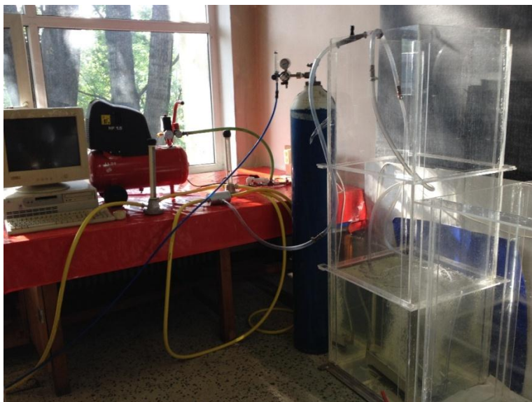
Fig. 6.2. Vedere de ansamblu a instalației experimentale la insuflarea unui amestec de gaze (aer atmosferic și oxigen)
