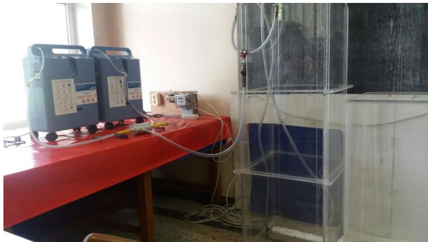
Fig. 6.3. Vedere de ansamblu a instalației experimentale la insuflarea de aer cu conținut redus de azot
