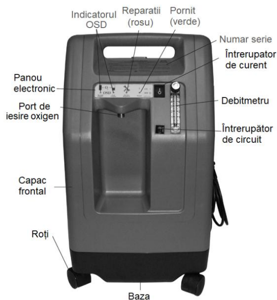
Fig. 4.2. Vedere din față a concentratorului de oxigen de tip DeVilbis [43]
