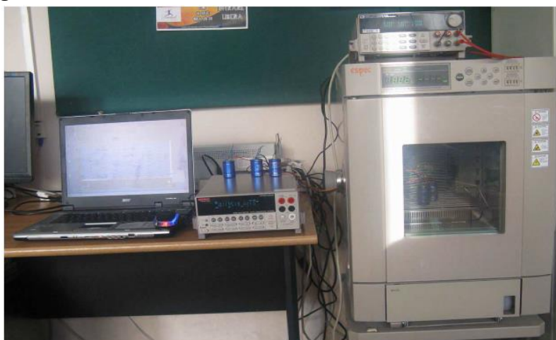
Fig. 4. 4 Sistemul de măsură cu supercondensatoarele supuse testării.
