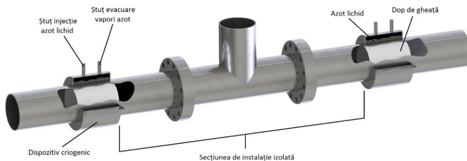
Fig. 1.2 - Izolarea cu două dopuri de gheață a unor elemente ale instalației
