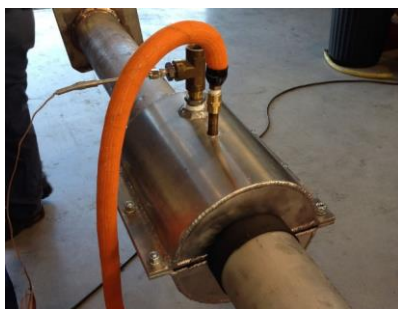
Fig. 1.1 - Manșon de înghețare rigid cu circulație de azot lichid
