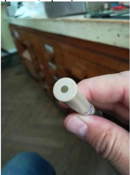
Fig. 4.4. Electrode de carbon vitros modificat prin CPE
