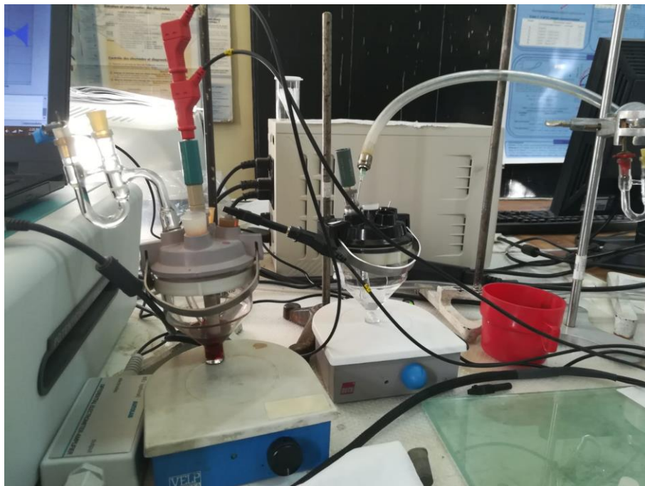
Fig. 4.3. Celule pentru prepararea de CMEs prin electroliză la potențial controlat (stânga) și pentru conditionarea lor (dreapta)
