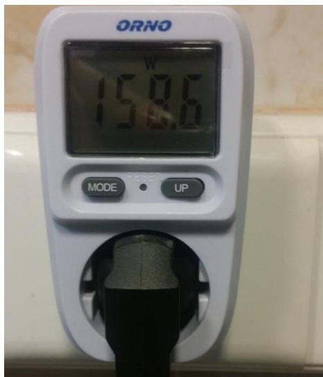
Fig. 5.15 Calculator de energie cu afișaj Orno OR-WAT-419(GS)
