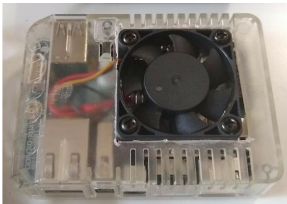
Fig.3.2. Mini-calculator bazat pe ARM cu o singură placă și cu sistem de răcire personalizat
