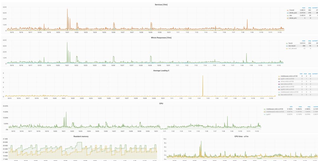
Figure 6.3: Serii de timp asociate cu monitorizarea serviciului Whois, vizualizate în Grafana și stocate în Prometheus și OpenTSDB
