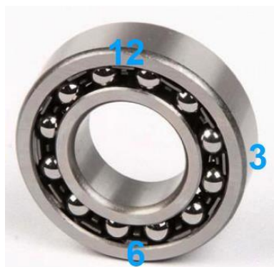
Fig. 13. Plasarea defectelor relativ la zona de încărcare (6), opus zonei de încărcare (12) și ortogonal acesteia (3).
