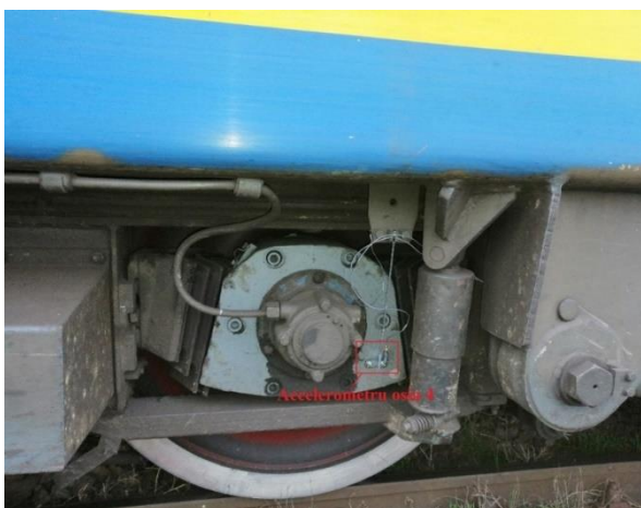
Fig. 48. Accelerometru amplasat pe cutia osiei 4 a locomotivei.
