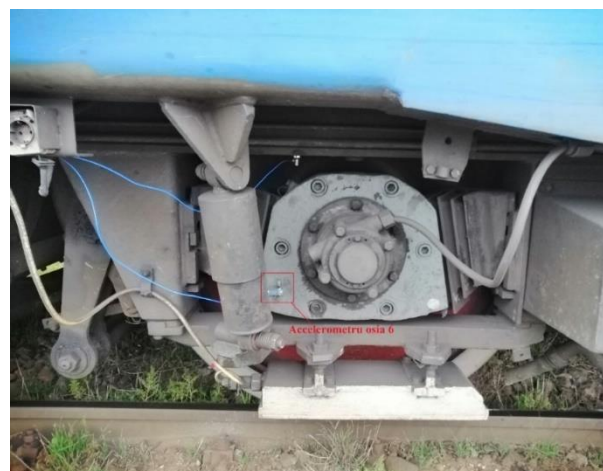
Fig. 49. Accelerometru amplasat pe cutia osiei 6 a locomotivei.
