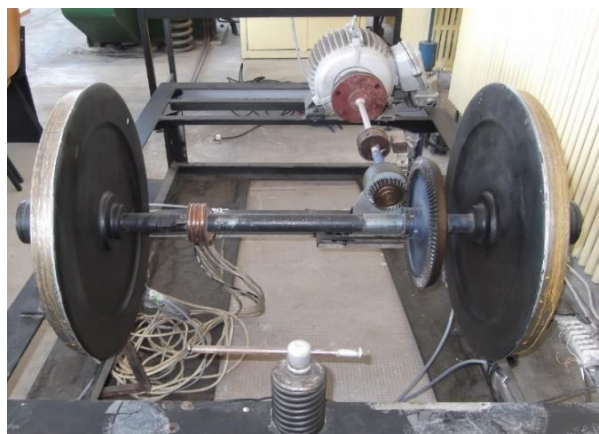
Fig. 42. Stand experimental pentru determinarea torsiunii osiei motoare
