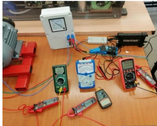
Fig. 46. Instrumentele de măsură utilizate pentru determinarea parametrilor electrici de funcționare ai mașinilor electrice.
