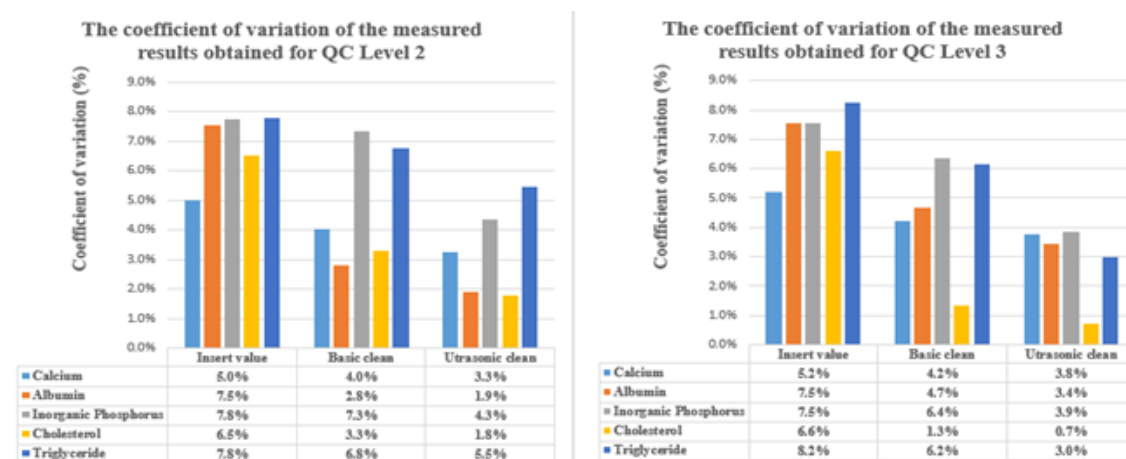
Figura 6.3 Coeficienții de variație pentru probele QC analizate cu și fără prototip.
