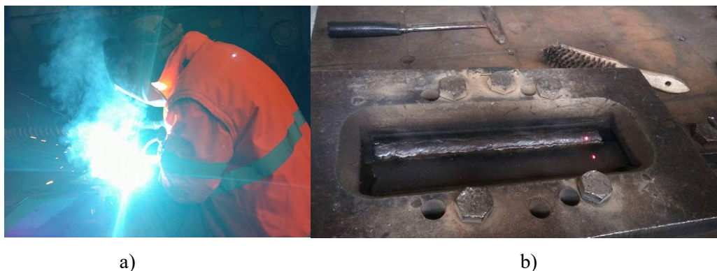
Fig. 6.38. Sudare FCAW semi-mecanizată a) Depunerea manuală a CS prin procedeul FCAW , b) CS deșus prin FCAW
