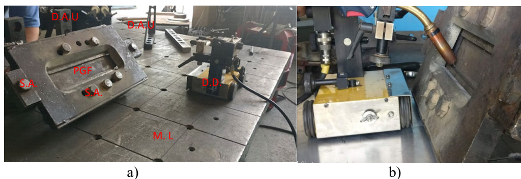
Fig. 6.40. Stand experimental – recondiționarea prin procedeul FCAWm a) poziționare probă în dispozitiv la 45°, b) poziționare pistol de sudare S.A – sistem asamblare dispozitiv, M.L. – masa de lucru, PGF – port-garnitura frecare, D.D – dispozitiv desplasare pistol de sudare (pentru mecanizare), D.A.U. – dispozitive de asigurare a unghiului de inclinare
