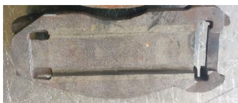
Piesă cu uzură ce permite recondiționarea
