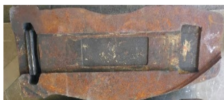
Piesă cu uzură ce nu permite recondiționarea
