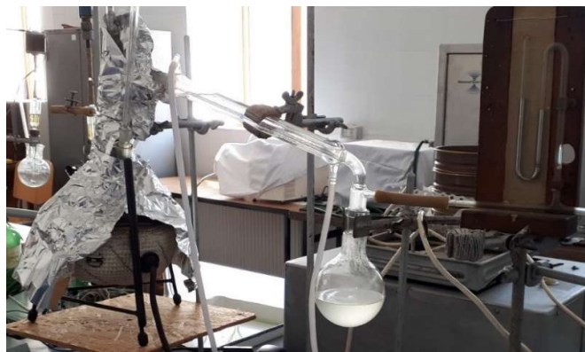
Figura 70. Instalația de distilare la vid utilizată pentru purificarea esterilor etilici
