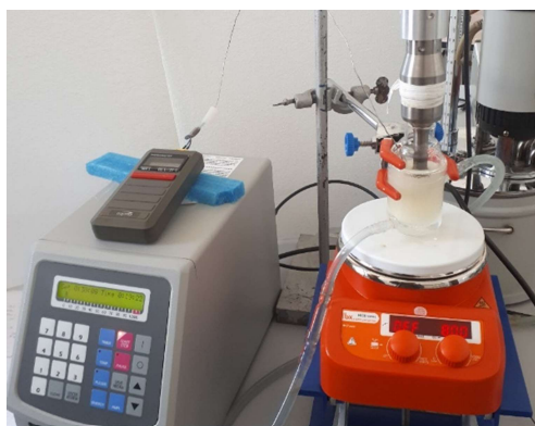
Figura 76. Sinteza asistată de ultrasunete a esterilor etilici în prezența unei soluții apoase de bromură de sodiu
