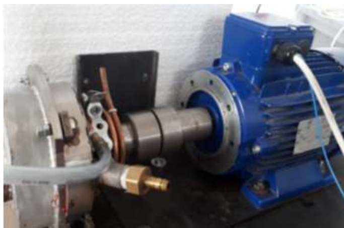
Figura 48. Instalație reactor de hidrocavitație în construcția cu o singură trecere și manta de răcire
