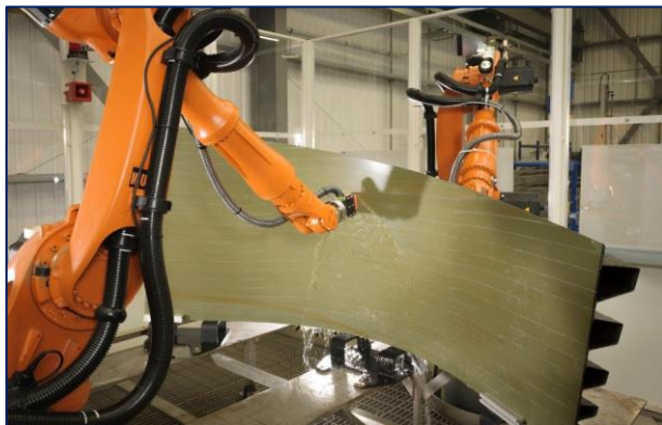
Fig. 1.22 – Robot industrial-braț-articulat folosit în NDT [22]
