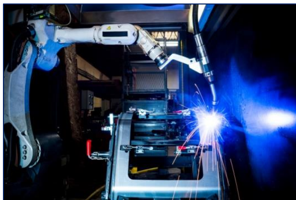
Fig. 1.24 – Robot industrial-braț-articulat folosit pentru sudură [22]
