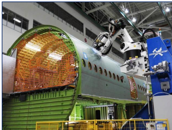
Fig. 1.23 – Robot industrial-braț-articulat folosit pentru găurire și fixare [22]
