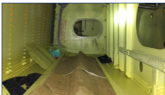
Fig. 4.12 – Îndepărtarea urmelor de kerosen rămase în rezervorul central de combustibil al avionului Boeing 737-300 [47]
