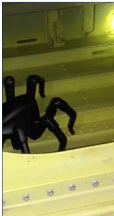
Fig. 4.14 a - Robotul mobil hexapod AFTRH aflat în poziție staționară în interiorul rezervorului central de combustibil al avionului Boeing 737-300
