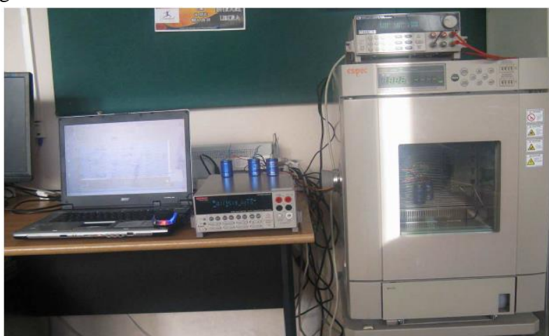
Fig. 4. 4 Sistemul de măsură cu supercondensatoarele supuse testării.
