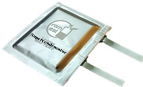
Fig. 7. 10 Celula de tip Pouch realizată în laboratorul ROM-EST, ICSI, Râmnicu Vâlcea.
