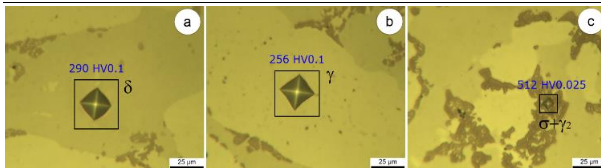
Figura 7.2 Imagini optice ale imprimării de microduritate a fazei de ferită ( \delta ) (a), de austenită ( \gamma ) fazei (b) și fazelor sigma și austenită secundară ( \sigma + \gamma_2 ) (c).
