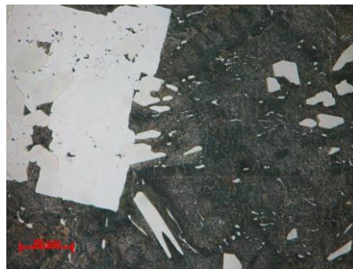
Fig. 3.2. Microstructura aliajului YSn83 turnat (900 ×)
