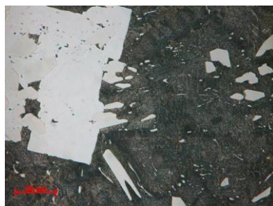
Fig. 3.2. Microstructura aliajului YSn83 turnat (900 \times )
