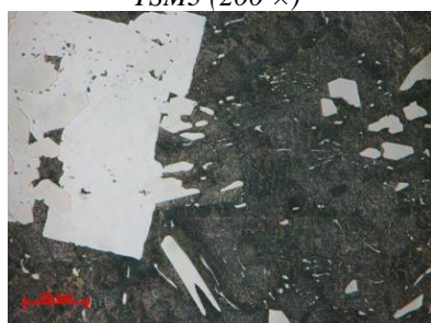
Fig. 3.8. Evoluția microstructurii aliajului de bază (a) și a aliajului microaliat YSM4 (b)
