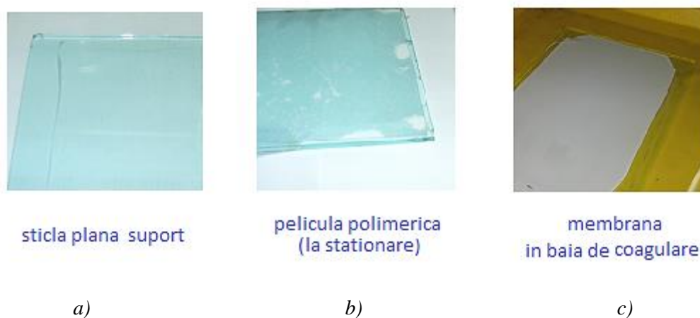
Fig. 2.8 . Pelicula polimerică în etapa studiată (săgeata din SCHEMA), între peliculizare (a), staționare în mediu (b) și coagulare în baie (c).
