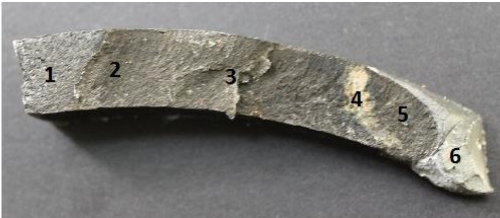
Figura 5.17 Aspect macroscopic al suprafeței probei fisurate (tubul nr.51)
