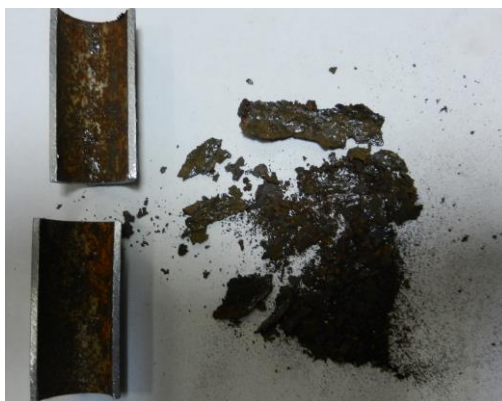
Figura 5. 12 Depuneri de reziduuri pe suprafețele interioare ale țevilor schimbătorului de căldură.
