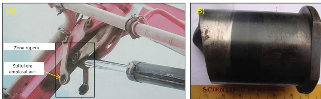
Figura 2. 6. (A) Locația defecțiunii știftului brațului la dispozitivul de plasare a brațului, (B) știftul brațului defect [137]
