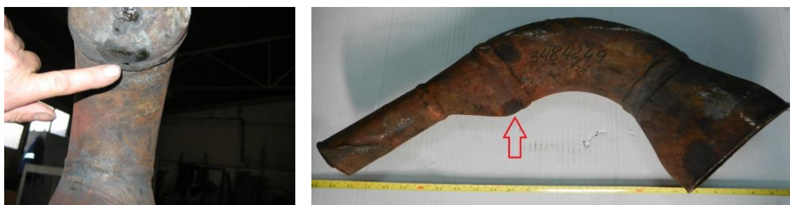
Figura 5. 24 Aspectul macroscopic al suprafețelor exterioare afectate de prezența porilor datorăți coroziunii (zona reducăției DN 100/DN50 realizată prin sudare – conducta GH – 120-201)
