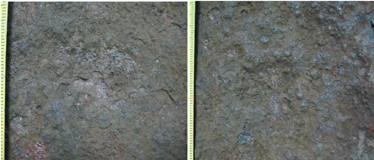
Figura 5. 9 Detalii asupra suprafeței interioare a peretelui mantalei schimbătorului de căldură 120 SID
