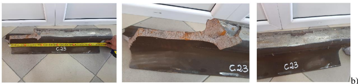
Figura 5. 29 Aspectul macroscopic al eșantioanelor din șine degradate: a – proba C1; b – proba C23;
