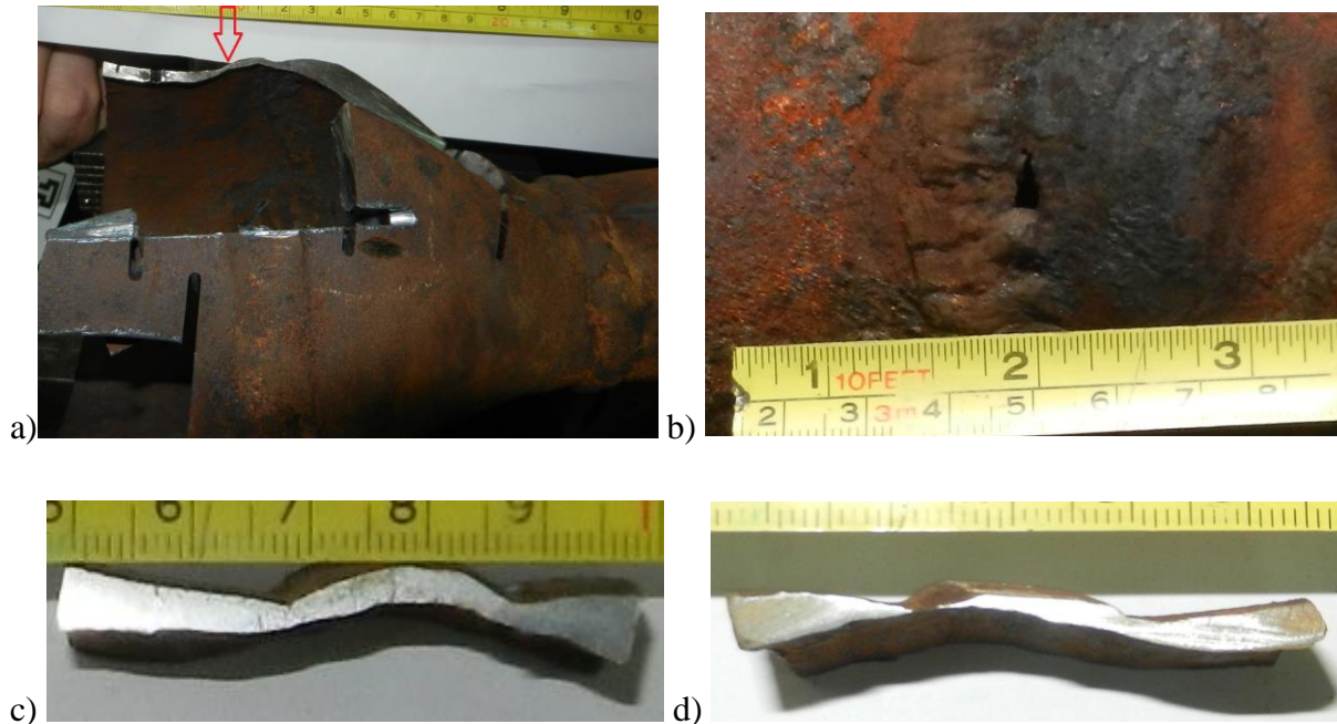
Figura 5. 26 Aspectul macroscopic al zonei îmbinării sudate a reducăiei DN100/DN50 și a cotelui DN100, în zona de formare a porului. a) ansamblul îmbinării după prelevarea probelor; b) detaliu al suprafeței îmbinării, în zona porului; c) secțiune în peretele conductei, la 30 mm de por; d) secțiune în peretele conductei, în locul formării porului
