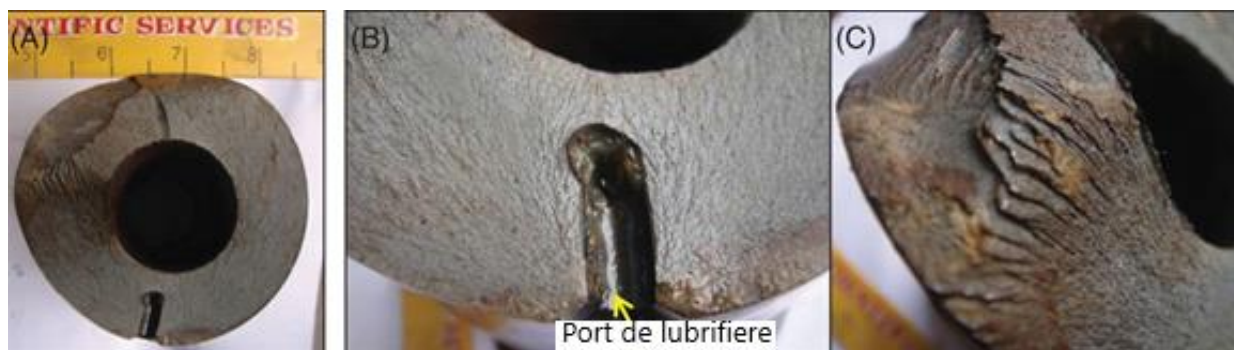
Figura 2. 7. (A) Suprafața de fractură a știftului brațului, (B) inițierea semnelor chevron din portul de lubrifiere care indică o fractură fragilă și (C) semne radiale care sugerează fractura fragilă a știftului brațului [137]
