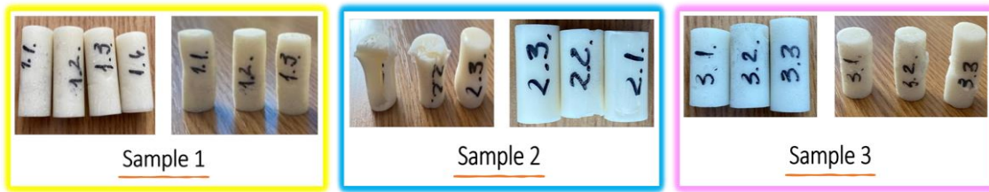
Figura 4.17. Imagine a probelor 1 (galben), 2 (albastru) și 3 (roz), înainte și după încercarea de rezistență la compresiune (înainte de compresiune - stânga, după comprimare - dreapta)
